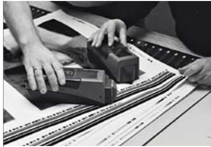
Die messtechnische Überprüfung des Druckes: Erst bei einer Dichte von 3.0 ist der maximale Kontrastumfang des menschlichen Sehens und damit auch das Maximum an Räumlichkeit (Plastizität) einer Bildwiedergabe erreicht.
